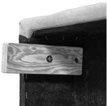
4. Zu montierenden Rücken auf die Montagehilfe aufsetzen.
