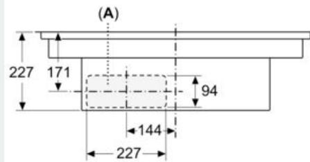
A: Direkt an der Rückseite angeschlossen
