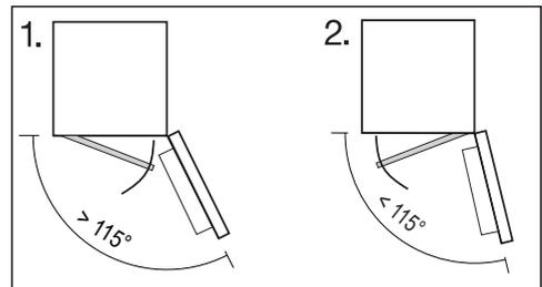
Je nach Öffnungswinkel der Gerätetür ist ein Anschlagwechsel der Gefrierfachtür notwendig.
