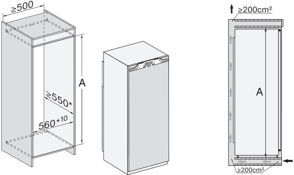
\* Der deklarierte Energieverbrauch wurde mit einer Nischentiefe von 560 mm ermittelt. Das Kältegerät ist bei einer Nischentiefe von 550 mm voll funktionsfähig, hat aber einen geringfügig höheren Energieverbrauch.
