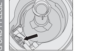
**Tipp:** Unter der Abdeckung befindet sich die Ablaufpumpe (Pfeil).
