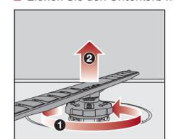
■ Drehen Sie die Verschraubung des unteren Sprüharms gegen den Uhrzeigersinn **1** (Blickrichtung von oben) und ziehen Sie den Sprüharm nach oben ab **2**.
