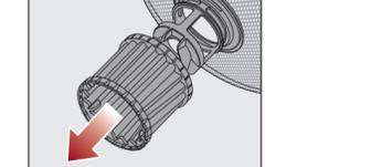
■ Zum Reinigen der Siebinnenseite ziehen Sie den Mikrofilter an dem Kunststoffring nach unten von der Siebkombination ab.
