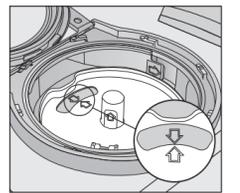
■ Ziehen Sie die gelbe Öffnungslasche in Pfeilrichtung **1** und legen Sie gleichzeitig die Aufnahme der PowerDisk wieder ein **2**. Dabei müssen die Pfeile in der Aufnahme der PowerDisk und im Sichtfenster zueinander zeigen. Die Aufnahme muss flächig aufliegen.
