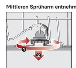
■ Drehen Sie die Verschraubung des mittleren Sprüharms im Uhrzeigersinn **1** (Blickrichtung von oben) und nehmen Sie den Sprüharm ab **2**.
