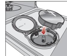
■ Legen Sie eine PowerDisk ein und drücken Sie sie gleichmäßig herunter, bis sie bündig aufliegt.
