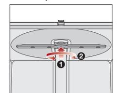
■ Drücken Sie den oberen Sprüharm hoch **1**, damit die innere Verzahnung einrastet, und schrauben Sie ihn gegen den Uhrzeigersinn ab **2** (Blickrichtung von unten).
