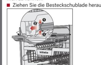
■ Drücken Sie die Sicherungsklammern der Schienen an beiden Seiten der Besteckschublade zusammen **1** und entnehmen Sie die Sicherungsklammern **2**.
