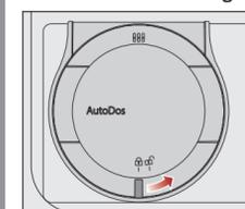
■ Für die automatische Reinigerdosierung drehen Sie den Deckel des AutoDos auf ☒ und öffnen Sie ihn.
