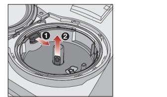
■ Entriegeln Sie die Aufnahme der PowerDisk durch Ziehen der gelben Öffnungslasche in Pfeilrichtung **1** und ziehen Sie gleichzeitig die Aufnahme der PowerDisk an den gelben Griffflächen nach oben ab **2**.
