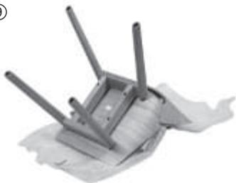
Ziehen Sie die Schrauben mit dem Sechskantschlüssel gleichmäßig an. Gehen Sie dabei in diagonaler Reihenfolge vor. Bitte prüfen Sie die Festigkeit der Schrauben.
