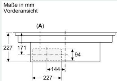
A: Direkt an der Rückseite angeschlossen
