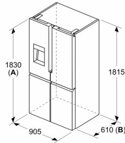
**A:** Front ist von 1830–1847 mm, bei voll ausgezogenen vorderen Nivellierfüßen, verstellbar
