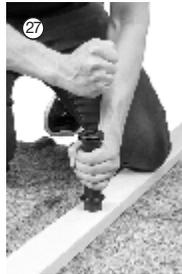
Stützfuß in das vorgeborte Loch an der Unterseite des Mittelholms einbringen.
