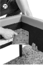
Fußteil ausrichten. Winkel an Fußteil ansetzen (noch nicht festziehen).
