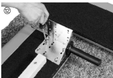
Winkel mit vormontierten FüÙen am Fußende der Bettseiten an den Positionen der Schraublöcher anlegen. Winkel mit den herausgedrehten Schrauben ansetzen (noch nicht festziehen).
