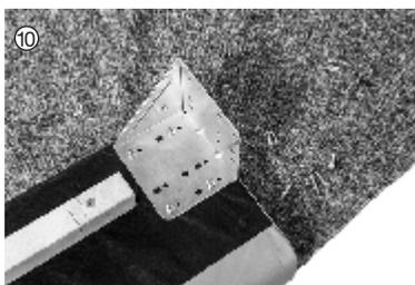
Winkel (ohne montierte FüÙe) am oberen Ende der Bettseiten Richtung Kopfteil an die Position der Schraublöcher anlegen. Winkel mit herausgedrehten Schrauben ansetzen. (noch nicht festziehen)
