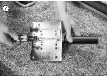
⑦ Einzelfuß an Unterseite des Winkels montieren, unter Verwendung der beigefügten Linsen Kopf-Schrauben M8x20 und den Unterlegscheiben Ø24mm.
