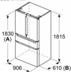
**A:** Front ist von 1830 bis 1847 mm, bei voll ausgezogenen vorderen Nivellierfüßen, verstellbar
