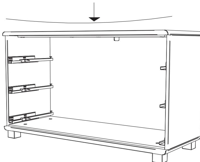
Falls der Kommodendeckel etwas "durchhängt" kann mit Hilfe eines Schraubenschlüssels die Spannvorrichtung nachgezogen werden, dadurch wird der Deckel wieder nach oben gedrückt.
