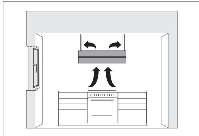
L'appareil est utilisé en mode recyclage d'air.
