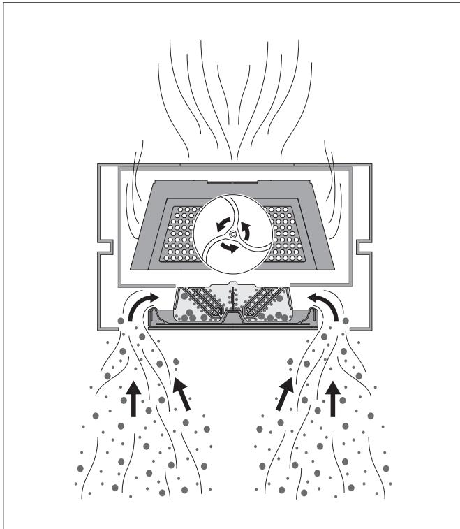
I vapori di cottura vengono aspirati nella cappa attraverso una fessura, accelerati e deviati a forma d'arco.
