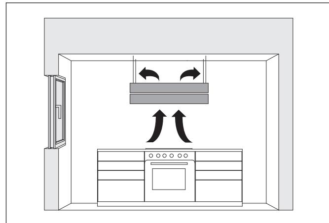
Het apparaat wordt gebruikt in de bedrijfsmodus Luchtcirculatiemodus.
